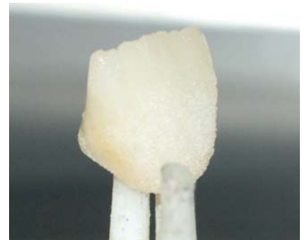
Abb. 6 Zirkonoxid besitzt keine lichteptischen Eigenschaften. Deshalb werden die Kronen mit einem sogenannten „FLU Bake“ vorbehandelt.
