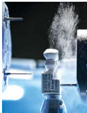
Cerec Zirconia kann mit der Cerec Schleif- und Fräseinheit trocken bearbeitet werden.
