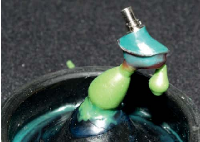
Abb. 16 und 17 Umsetzung des Primärteils in eine Goldlegierung mittels Gusstechnik
